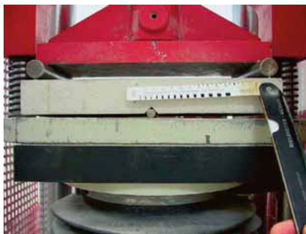
Foto: test per la misurazione della crack bridging ability.
