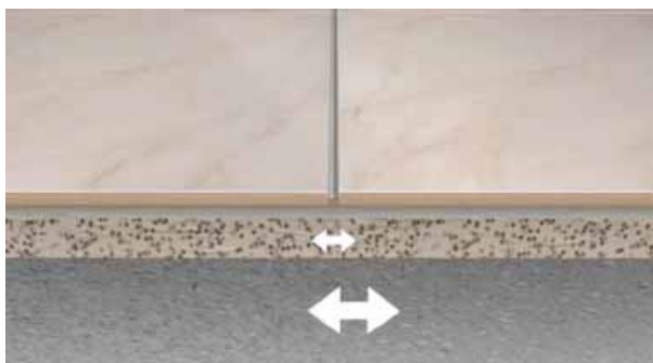
PCI Nanosilent assorbe elasticamente le deformazioni del supporto ed evita così che la fessurazione si propaghi sino al rivestimento
