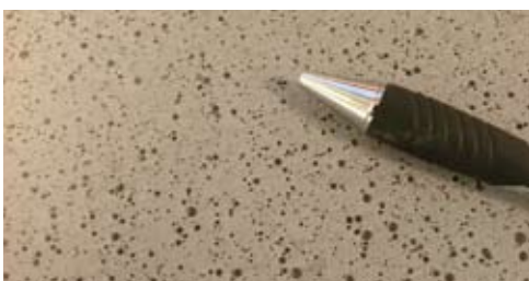
▲ Particolare di una superficie di malta dopo prova del sottopiastra non accettabile: presenza di eccessivo numero di bolle in interfaccia anche di ampie dimensioni
