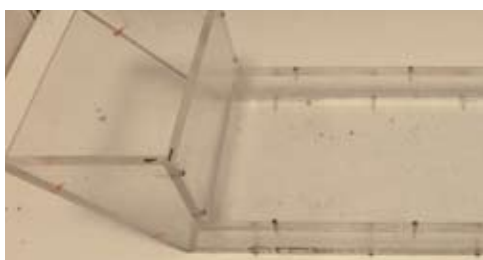
▲ Sottopiastra in plexiglass per la valutazione della quantità e della dimensione delle bolle d'aria in interfaccia
