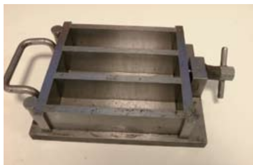
▲ Casseri metallici per le prove di resistenza a compressione ed a trazione per flessione della malte per ancoraggio (UNI EN 12190)
