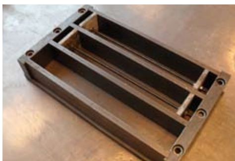
▲ Prova per la misurazione dell'espansione in fase plastica per le malte di ancoraggio (UNI 8996)
