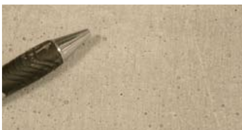
▲ Particolare di una superficie di malta dopo prova del sottopiastra non accettabile: presenza di eccessivo numero di bolle in interfaccia anche di ampie dimensioni
