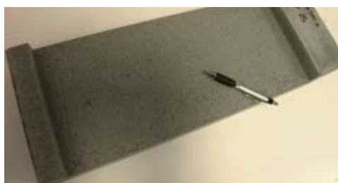
▲ Sottopiastra in plexiglass per la valutazione della quantità e della dimensione delle bolle d'aria in interfaccia
