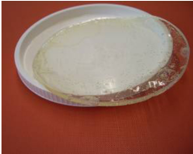
Fig. 1 MEYCO MP 350 dopo stagionatura all'aria umida.
