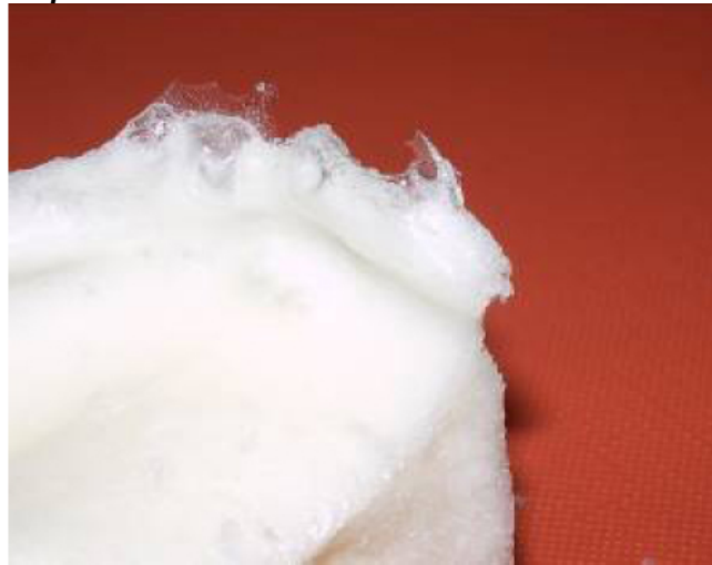
Fig. 2 MEYCO MP 350 dopo reazione schiumosa in acqua.
